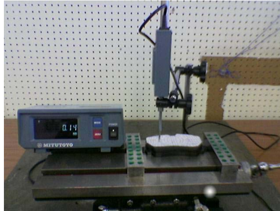
RAJAH 5 Alat pengukur lurus digunakan untuk mendapatkan taburan ketinggian permukaan bahan geseran
