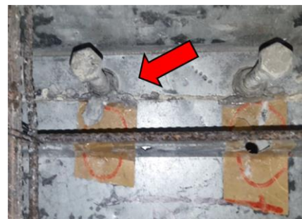
(d) IJT-06 shear connector
