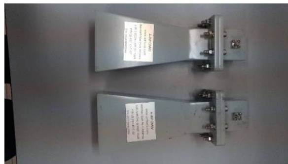
Fig. 3 - Horn antennas (Model: A-INFO LB-187-10, 3.95 -5.85 GHz)
