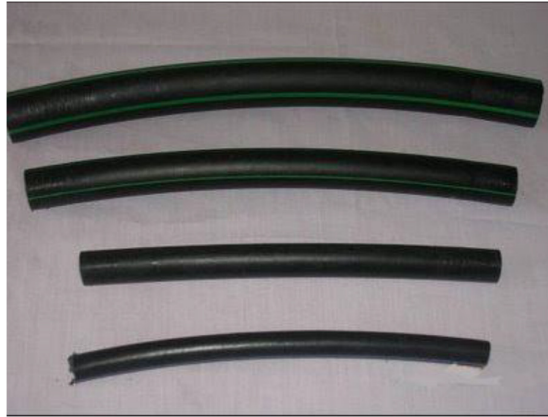
Fig. 3. Pipe of HDPE Material Grade PE 80 [17]
