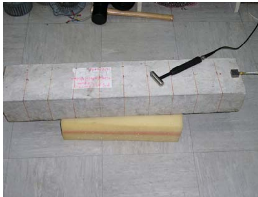
Rajah 5.5 : Rasuk diletak di atas span
