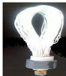
Fig. 2. U-shape ultrafiltration membrane module
