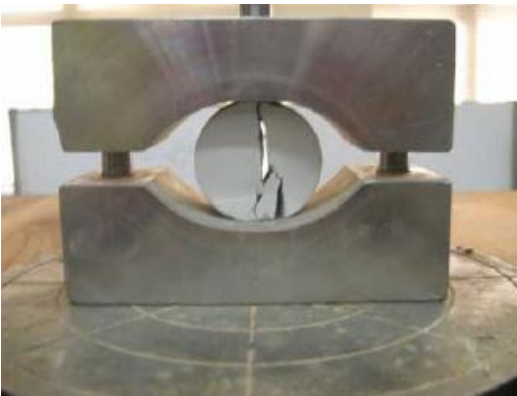
(d) Indirect tensile test or Brazilian test
