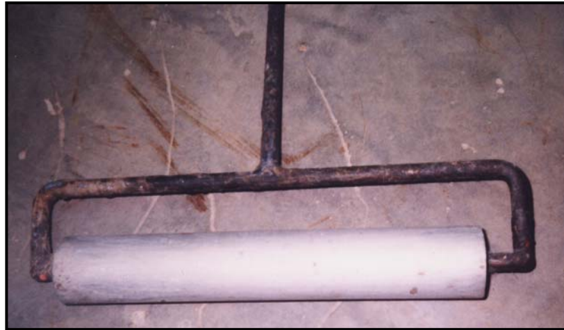
Rajah 3.15: Rola keluli digunakan untuk menekan kepingan CFRP kepada rasuk konkrit.
