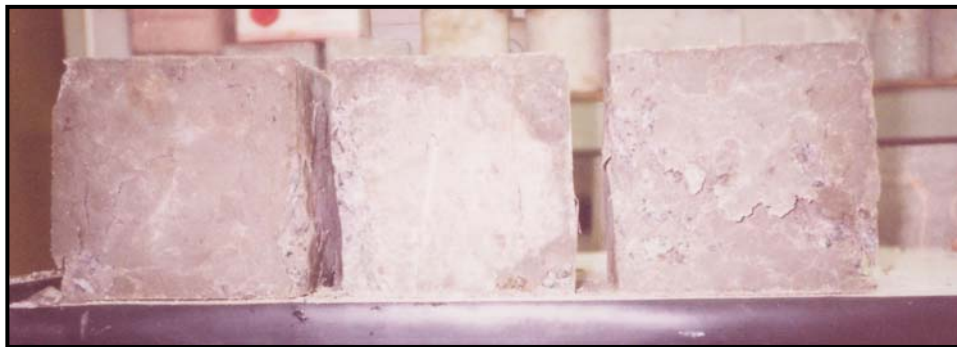
Rajah 3.10 : Kiub konkrit yang telah melalui ujian kekuatan mampatan konkrit.
