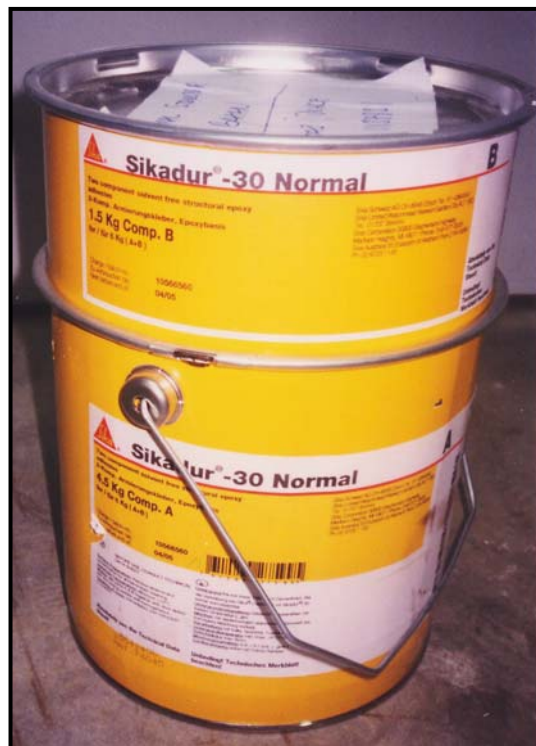
Rajah 3.16: Sikadur-30 Normal adhesive terdiri daripada komponen A (epoksi) dan komponen B ( hardener )
