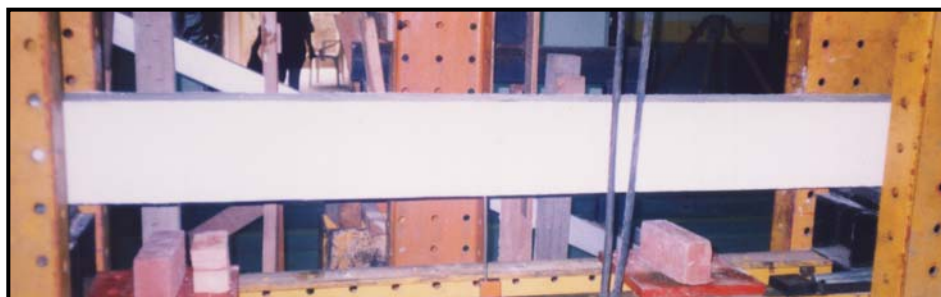
Rajah 3.11: Rasuk A (pra-keretakan) setelah pembebanan dilepaskan sepenuhnya.
