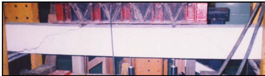
Rajah 4.10: Keretakan pada rasuk BS-2T16
