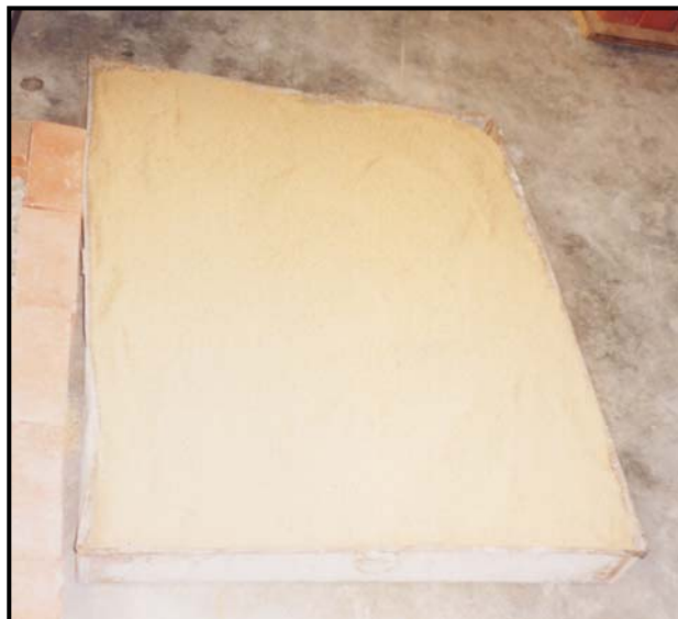
Rajah 3.9 : Pasir yang telah diayak, dikumpul dan dijemur selama 3 hari sebelum digunakan.
