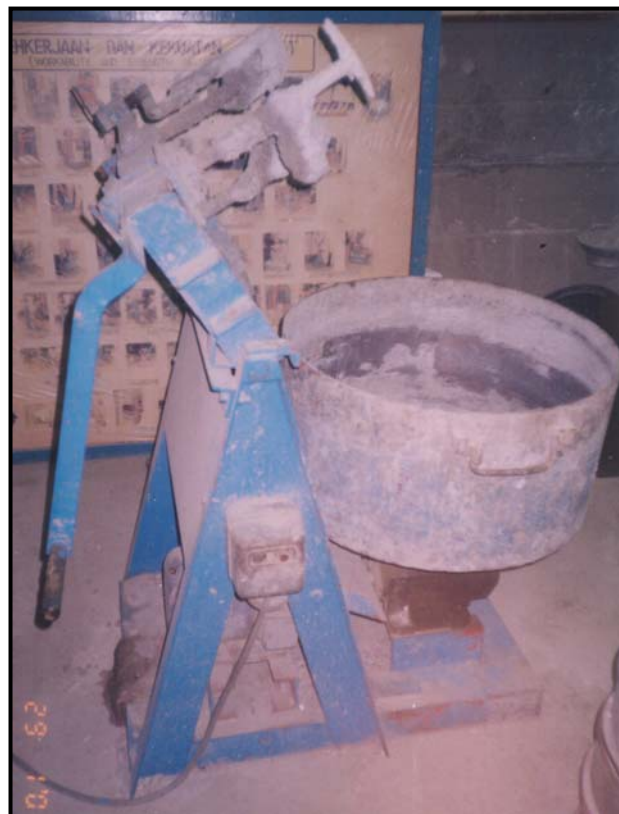
Rajah 4.1: Drum mixer digunakan untuk mengaul bancuhan konkrit.
