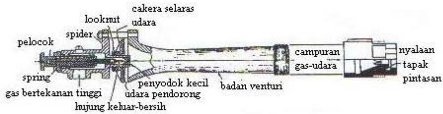
Rajah 2.2 'Inspirator' atau Pencampur Jet Gas (Perry, 1997).
