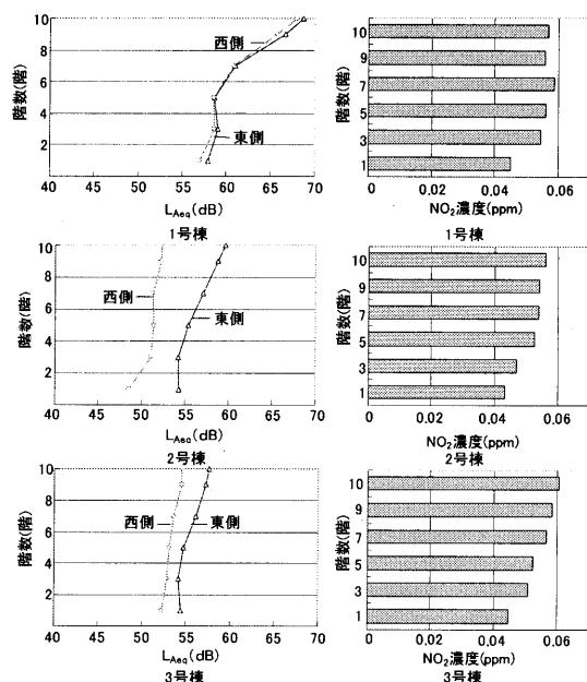
図4 S自治会地区の各住棟における $L_{Aeq}$ の鉛直分布図7 S自治会地区の各住棟における $NO_2$ 濃度の階別平均値
